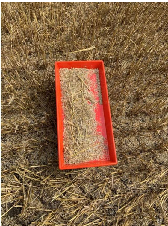
Ryc. 26. Tacka pomiarowa do określania strat ziarna (źródło: opracowanie własne)
