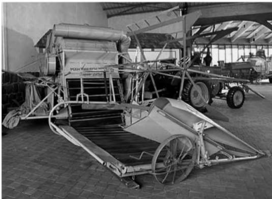
Ryc. 10. Pierwszy przyczepiany kombajn CLAAS z napędem przekazywanym od WOM ciągnika (źródło: Miu 2016)
