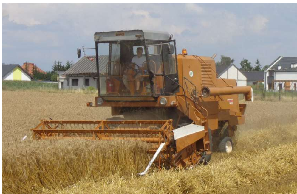
Ryc. 12. Kombajn polskiej produkcji: Bizon Z056 Super (źródło: opracowanie własne)
