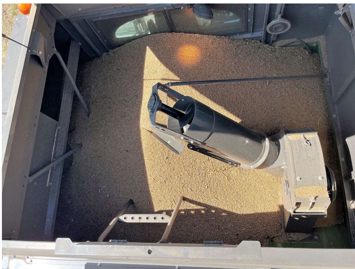
Ryc. 23. Zbiornik ziarna – miejsce pobierania próbek do określenia uszkodzeń i czystości ziarna (źródło: opracowanie własne)
